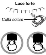
L'elettricità generata dalla cella solare dell'orologio viene accumulata da una pila ricaricabile. Se si lascia o se si usa l'orologio in luoghi in cui esso non è esposto alla luce, la pila si scarica. Accertarsi che l'orologio sia esposto il più possibile alla luce.
