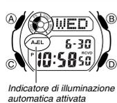
Questo orologio dispone di un pannello elettroluminescente (EL) che fa illuminare l'intero display per facilitare la visione delle indicazioni al buio. La funzione di illuminazione automatica dell'orologio fa accendere automaticamente l'illuminazione quando si orienta l'orologio verso il proprio viso per leggere le indicazioni.
